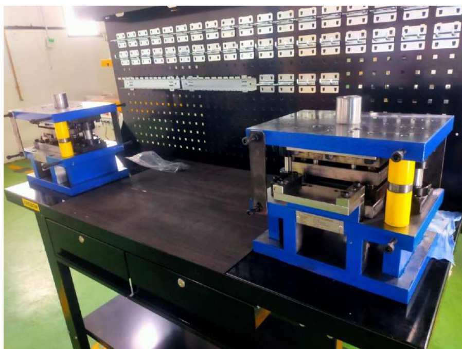
Perangkat Dies yang dibuat oleh IKM untuk memenuhi Pesanan dari Inggris
